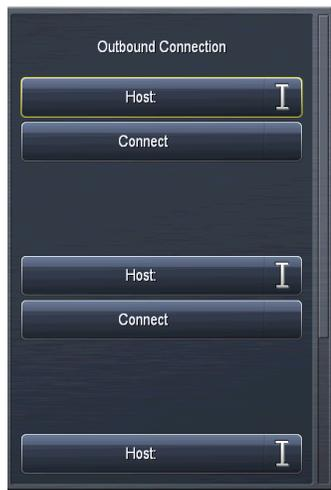
Un ejemplo de cómo esto se puede usar es para el soporte técnico. Al crear una conexión de salida, usted se puede conectar a la computadora NfRemote del ingeniero de asistencia técnica; lo que, a su vez, les permite controlar su Omnia.7.
