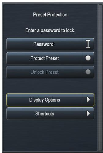
Para proteger con contraseña una preconfiguración, ingrese una contraseña en el menú Password (Contraseña) y seleccione “OK”; después, “Protect Preset (Proteger Preconfiguración)”. Aparecerá una ventana de diálogo de advertencia. Si su intención es realmente proteger la preconfiguración, seleccione “Yes (Sí)”.
