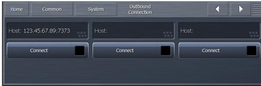
Un ejemplo de cómo esto se puede usar es para el soporte técnico. Al crear una conexión de salida, usted se está conectando a la computadora NfRemote del ingeniero de asistencia técnica; lo cual, a su vez, les permite controlar su Omnia.7.
