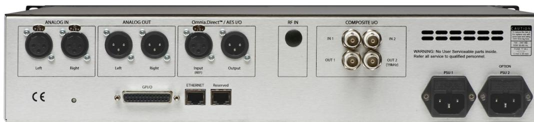
A continuación, conecte las entradas de audio según corresponda para su instalación. Omnia.7 acepta audio analógico de nivel de línea profesional y equilibrado a través de sus Entradas Analógicas Izquierda y Derecha y audio digital AES/EBU en conectores estándar XLR a través de sus entradas AES.
