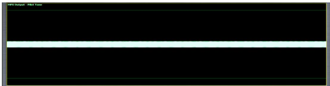
Note que lo que está viendo aquí es el piloto real que se extrajo de la señal MPX completa. Para ver cuán ajustada está la señal compuesta, compare la señal MPX completa con una sin piloto y note que el nivel del pico aumenta realmente cuando se elimina el piloto. Esto es exactamente lo opuesto a lo que observará con cualquier otro procesador (excepto Omnia.9).
