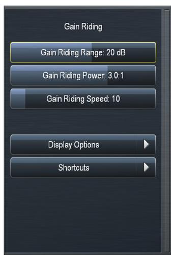
Las múltiples configuraciones individuales de las distintas secciones del AGC de banda ancha de Omnia.7 están controladas simultáneamente por las configuraciones en el menú **Gain Riding (Control de Ganancia)**.
