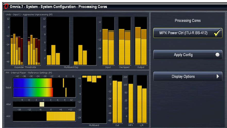
En el menú **FM > Processing > Load Preset (FM > Procesamiento > Cargar Preconfiguración)** notará que la lista de preconfiguraciones se actualizó para incluir específicamente las diseñadas para el uso de BS.412. También hay una opción adicional del menú **Power Limit (Limitación de Potencia)**.
