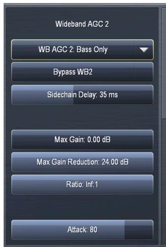
El menú **Wideband AGC 2 (AGC 2 de Banda Ancha)** proporciona los controles para determinar la ubicación y el tipo de compresor como así también todos los controles de ganancia esperada y velocidad.
